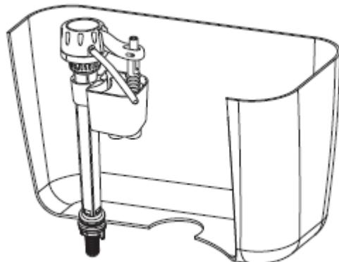
2. Po připojení přívodu vody přizpůsobte objem vody. Otočením nastavovacího šroubu po směru nebo proti směru hodinových ručiček nastavte plovák na požadovanou výšku.
