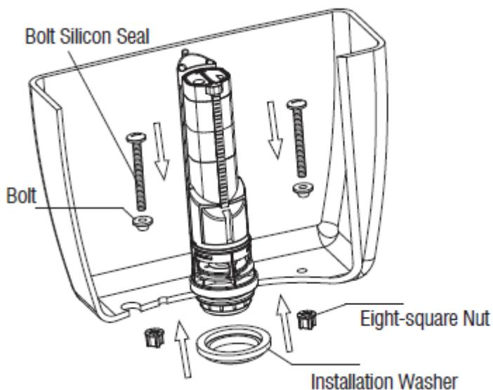
3. Uchopte tělo splachovacího ventilu a otočením po směru hodinových ručiček ho nasaděte zpět. Vložte těsnění na matici a WC nádržku umístěte na záchodovou mísu. Poté použijte šrouby a silikonová těsnění (jako na obrázku) a pevně přišroubujte osmihrannou matici.
