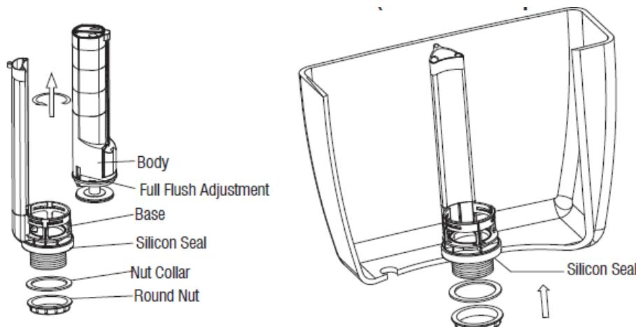
1. Otočením proti směru hodinových ručiček sejměte tělo splachovacího ventilu. Odšroubujte matici s podložkou.
