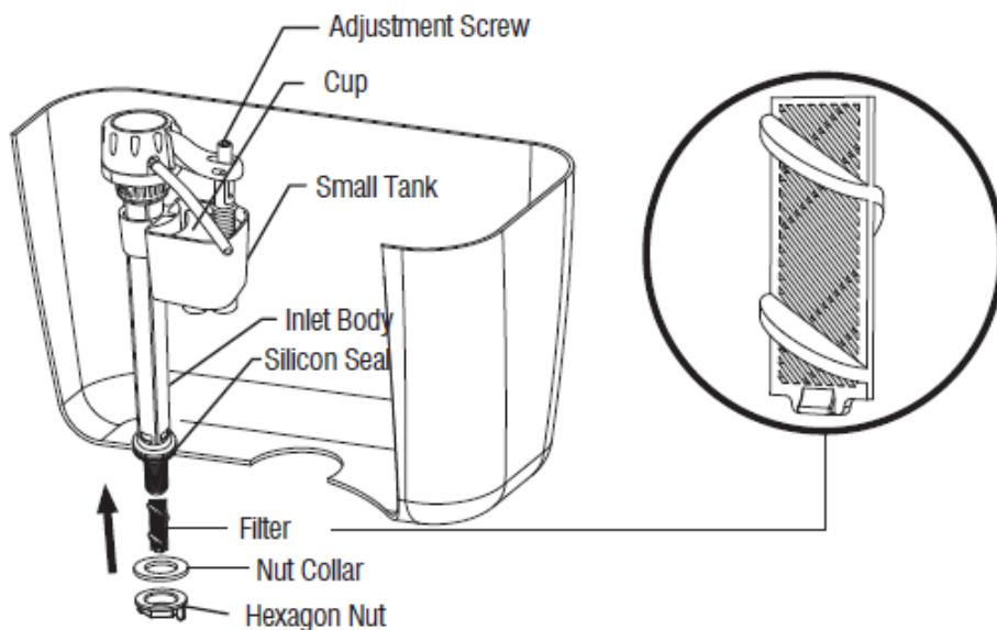
1. Odšroubujte šestíhrannou matici a podložku, vložte plnící ventil se silikonovým těsněním na příslušné místo. Poté zašroubujte šestíhrannou matici s podložkou pevně k plnícímu ventilu a připojte plnící trubku s přepadovou trubkou plnícího ventilu.
